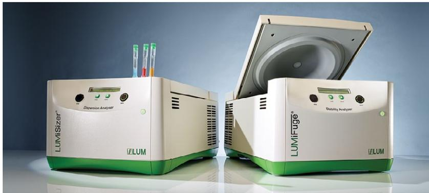
Die LUM GmbH hat auf Basis langjähriger wissenschaftlicher Erfahrungen in den Bereichen Fluid-Mechanik, Rheologie und Kolloidchemie ein analytisches Messverfahren entwickelt und im Markt etabliert, das es zuvor nicht gab – die STEP-Technologie®. Sie ermöglicht die In-site-Visualisierung von Alterungsprozessen von Suspensionen und Emulsionen quasi im
